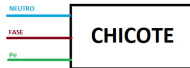
Si el horno es trifásico 220V se debe usar un disyuntor trifásico, conecte los cables de la siguiente manera: las 3 fases en el disyuntor y el cable de tierra directamente al aterramiento de la red (si no lo tiene, hacerlo de acuerdo con la NBR 5410).
